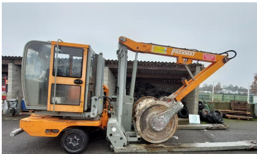
Image 2 : Compacteur de prêt _ Packmat System
