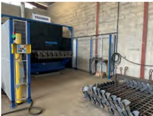
Un atelier important dans la chaîne de production est le **poste de soudure automatisé** qui permet de fabriquer les enclaves : barres-T, élingues,...
