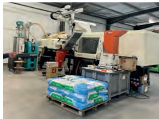
Après nous retrouvons l'**atelier d'injection**, tout automatisé, permettant de créer sur mesures toutes les pièces pour le montage des filets paragrêles : crochets, mousquetons, tops faciles,...
