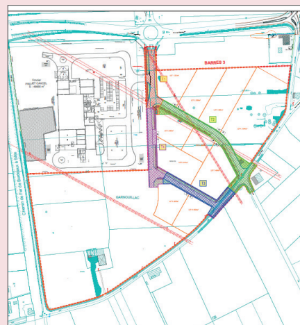
La première tranche de travaux comprend la voirie rouge et verte.
